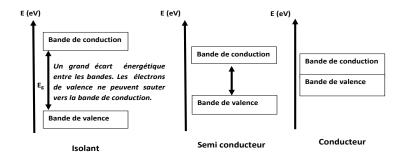
Un semi-conducteur possède un écart énergétique plus restreint, permettant à quelques électrons de sauter vers la bande de conduction et devenir des électrons libres.
