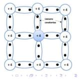
Dès que la température augmente, l'agitation des atomes entre eux va bousculer l'ordre établi et des électrons périphériques peuvent se retrouver arrachés à la liaison cristalline des atomes. Ces électrons se retrouvent à une distance des noyaux qui leur permet de se déplacer dans la plaquette de silicium. Le semi-conducteur est alors conducteur.
